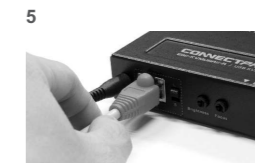
5 Link Cat.5 cable
